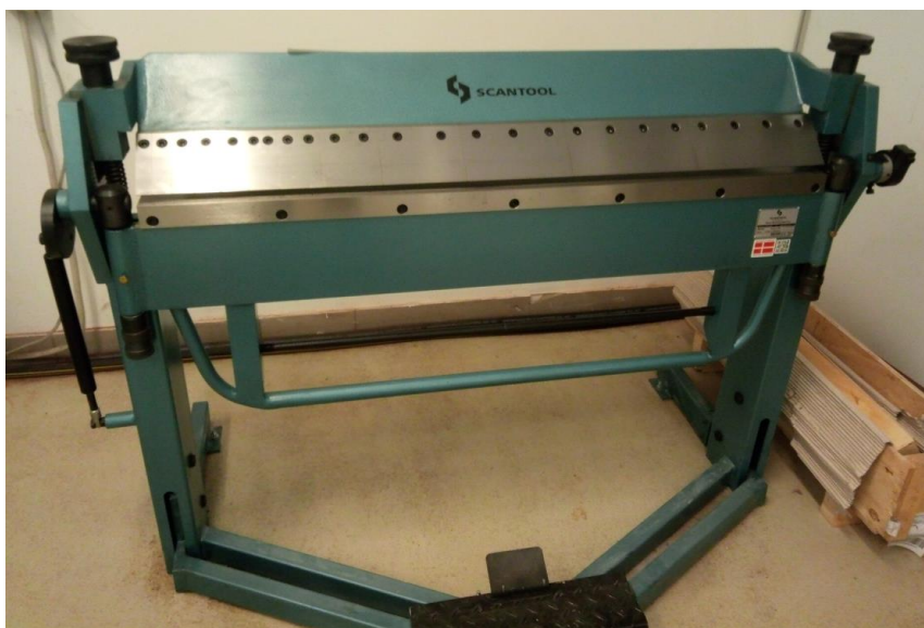
SCANTOOL 13S típusú kézi élhailító a lézertudatóriumban
