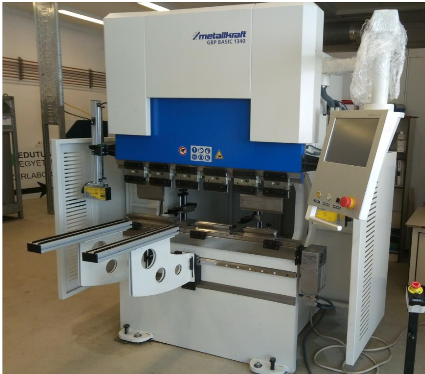
Metallkraft GBP 1340 Basic típusú, CNC vezérlésű hidraulikus élhajlító (40 t) a lézerlaboratóriumban
